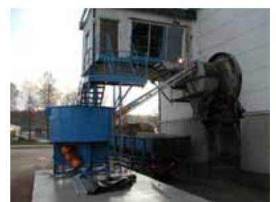
Installationsbeispiel von AB Färdig Betong, Schweden. Die Anlage ist auf ein Betonfundament montiert. Über ein Förderband werden die Fasern in den Mischerausgang befördert.
