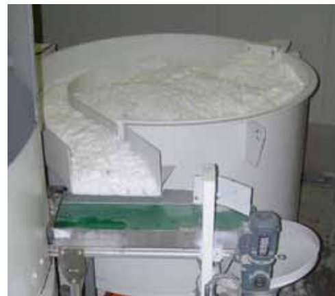
Dosieranlage Type MD500SX Behälter mit bis zu 400 kg PP-Faserinhalt. Fördermenge bis zu 15 kg/min.
