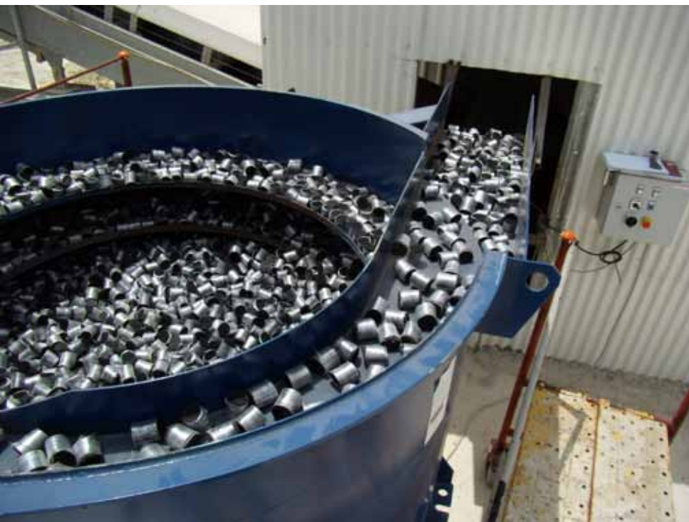
Dosieranlage Type MD500SX Dosierung von Macrofaser Pucks. Füllmenge 600 kg. Fördermenge 20 kg/min.
