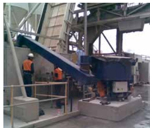
Dosieranlage Type MD500SX Behälter mit bis zu 400 kg PP-Faserinhalt. Fördermenge bis zu 15 kg/min.
